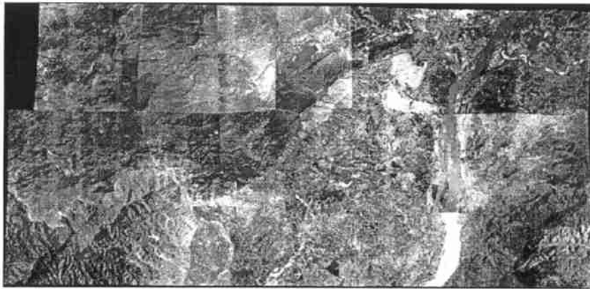
图 6 3 条航线共 24 片黑白图像几何镶嵌的结果(有明显的拼接缝效应)
