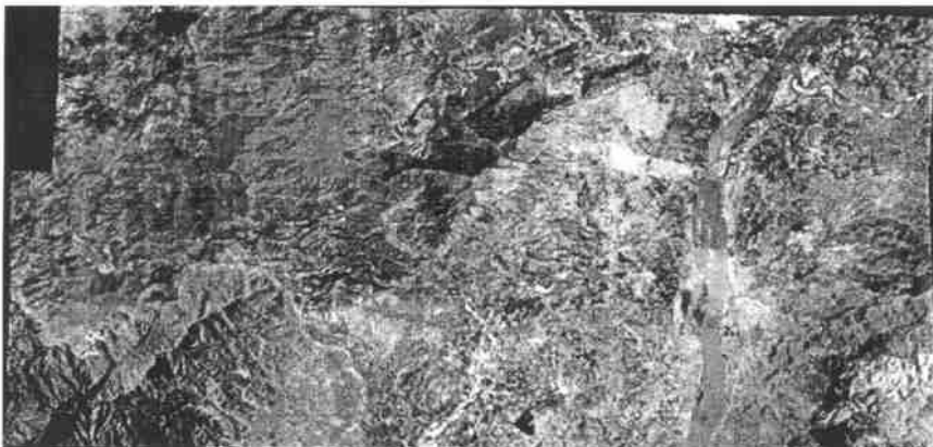
图 7 图 6 经过拼接缝处理后的结果(已没有拼接缝效应)
